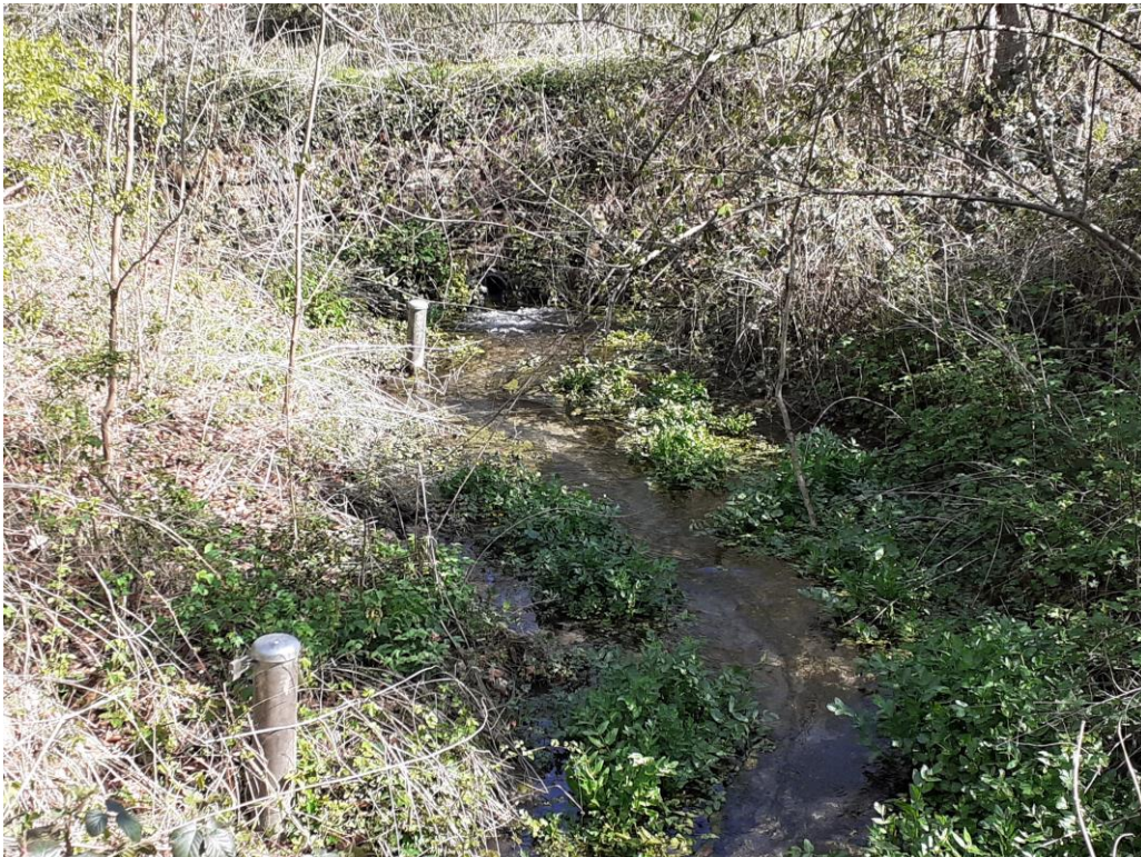
We naderen een belangrijk waterwingebied voor drinkwater. De peilbuizen zijn zichtbaar. Hiermee kun je de diepte, maar ook de kwaliteit van het grondwater meten.
